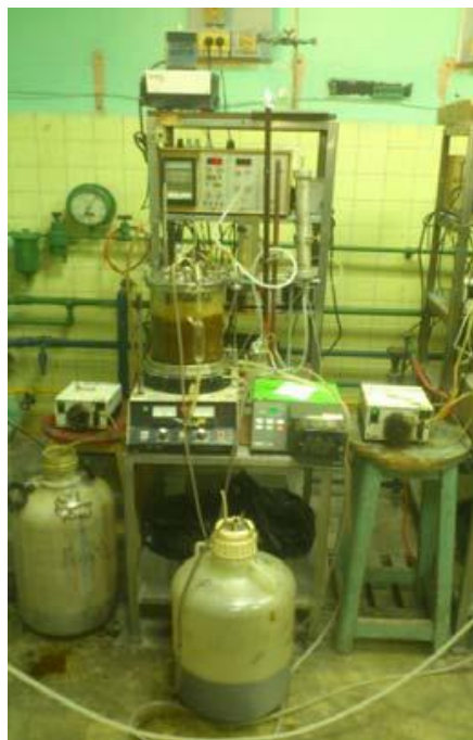
Figura 4. Vista del sistema de fermentación reactores Marubishi MD 300 (Japón). 5 L, 34°C, pH 4.5 ± 0.5, 1.2 vvm, 650 rpm.
